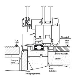
Bauanschluss mit Purenitprofil unten
